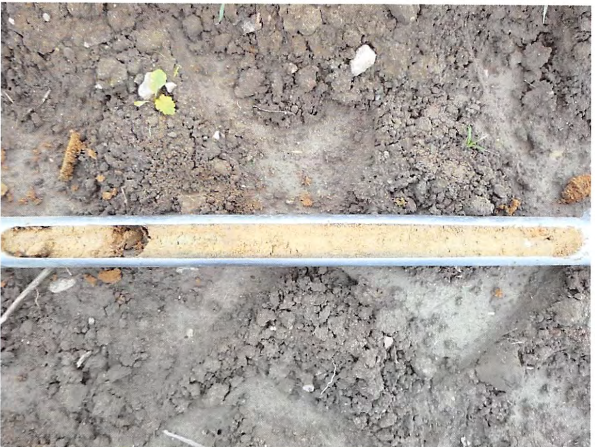
Bild 6: Sportplatz, O-Seite, Geschiebelehm, sandig, tonig bei 2,3-2,8 m.
