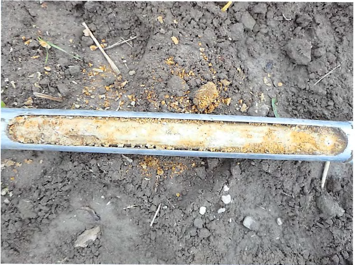
Bild 5: Mitte Wohnsiedlung, Geschiebelehm, stark sandig, schwach tonig, bei 0,5-1,0 m.
