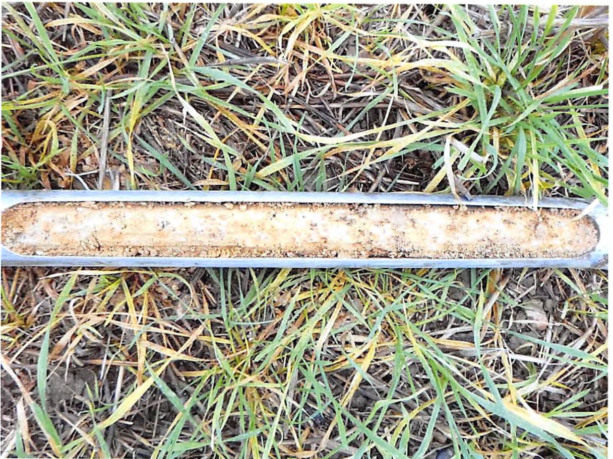
Bild 4: ALDI-Markt, NW-Ecke, Geschiebelehm, stark sandig, oberflächennah bei 0,5-1,0 m.
